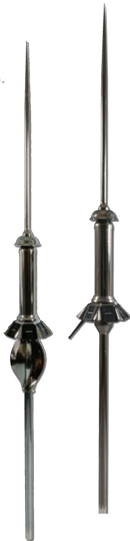
Saint-Elme Active 2D<sup>®</sup> 避雷针的创新在于：通过位于其头部的第二个传感器测量上行先导的强度。当下行先导进入避雷针的保护区域时，被测电流大大增强。当达到特定的阈值时，电容器就会放电，延伸上行先导，进而捕获雷云的下行先导。
